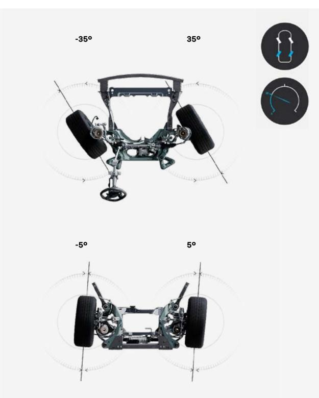
jusqu'à 50 km/h, les roues arrière tournent dans le sens opposé des roues avant pour réduire le diamètre de braquage et faciliter les manœuvres
