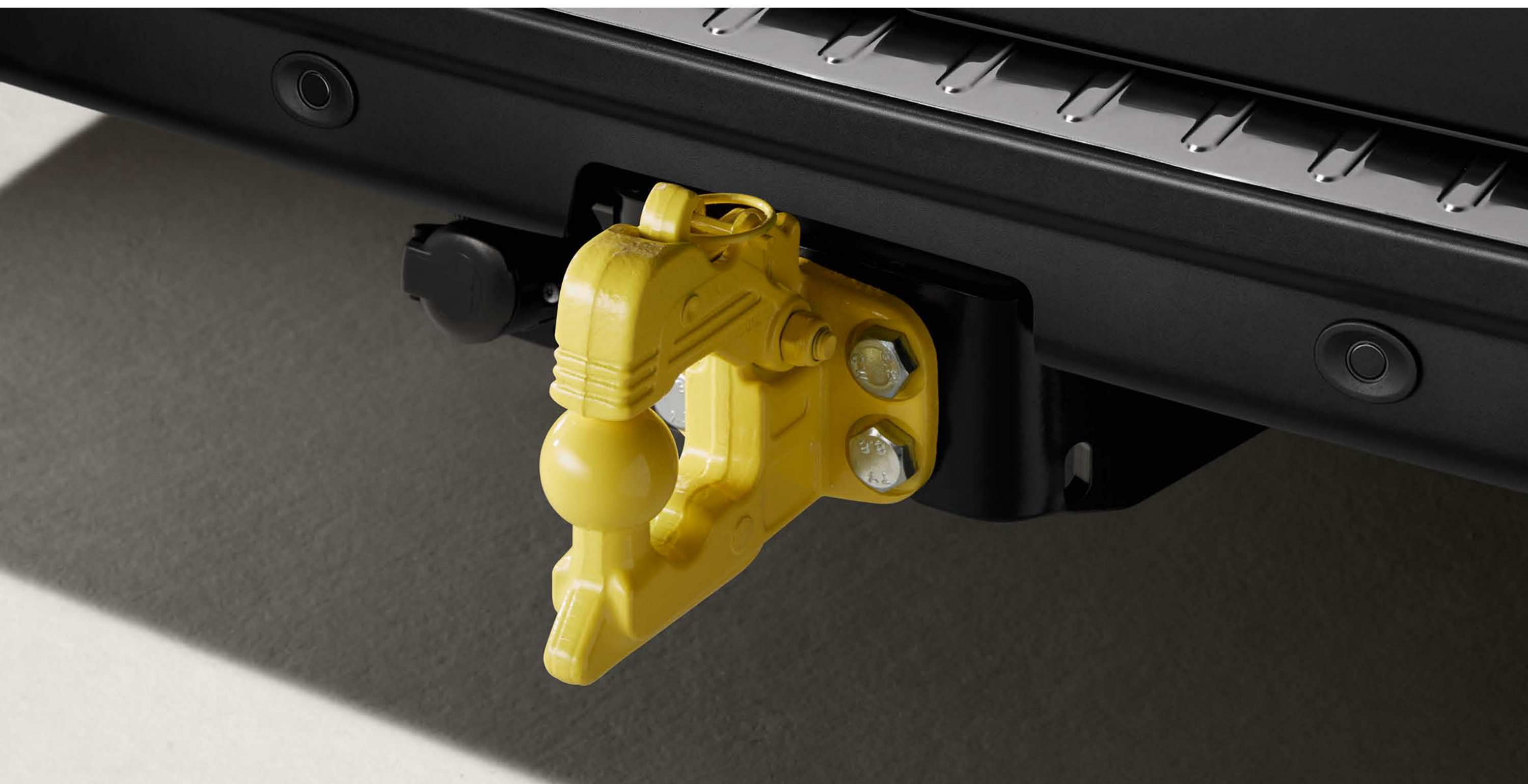
attelage standard - avec crochet mixte Permet de tracter des charges lourdes sans difficulté et en toute sécurité, il se démonte rapidement.
