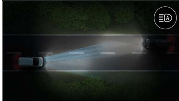
**La commutation automatique des feux de route** s'active automatiquement en fonction des sources lumineuses détectées et des conditions de circulation.
