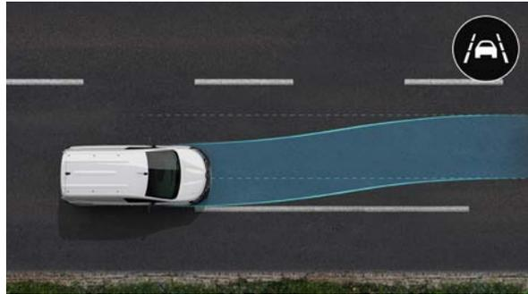
**Le système actif de maintien dans la voie** vous prévient, par un signal lumineux sur le tableau, du franchissement involontaire d'une ligne continue ou discontinue entre 70 km/h et 180 km/h. Le système peut également corriger la trajectoire du véhicule et le replacer au centre de la voie, évitant ainsi tout risque de collision.
