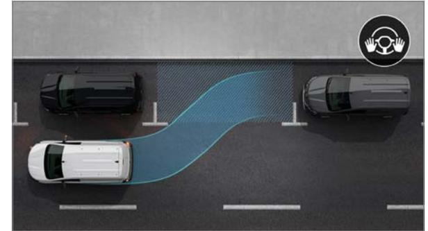
**Le système de parking mains-libres easy park assist** permet de se garer simplement. La recherche d'un emplacement de stationnement et la direction sont assurées par votre véhicule. Il vous suffit de gérer l'allure.
