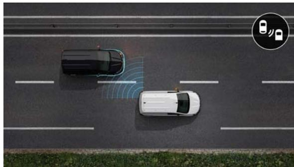
**Le système actif de surveillance d'angle mort**, actif entre 30 km/h et 180 km/h, vous alerte automatiquement via un signal lumineux de la présence d'un véhicule non visible dans le rétroviseur. Si besoin, le système peut appliquer une correction sur le volant, empêchant ainsi une collision latérale.
