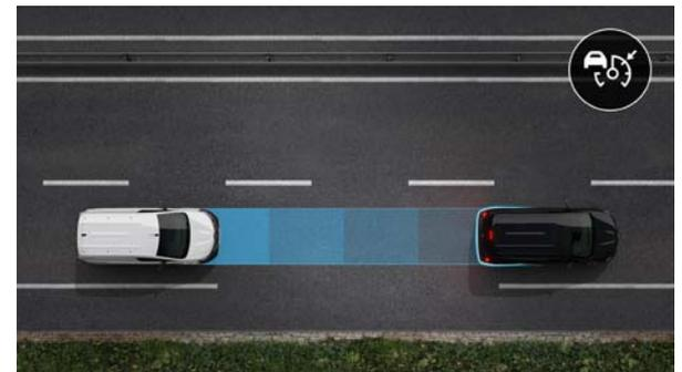
**Le régulateur de vitesse adaptatif \*** vous permet de conserver la distance de sécurité adéquate avec le véhicule devant vous. Le système agit sur le frein lorsque la distance est trop courte, et inversement sur l'accélérateur lorsque la route est de nouveau dégagée.
